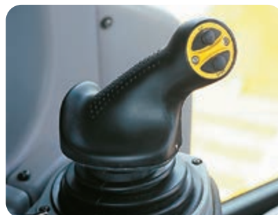
PCCS (Palm Command Control System) Systém ovládní stroje pohybem zápěstí
