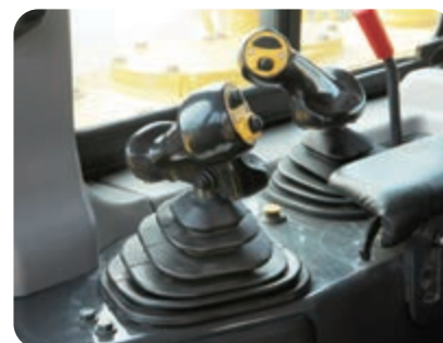
Páka ovládní radlice s automatickým úhlováním. Páka ovládní rozrývače a funkci automatického zvednutí při couvání
