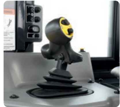
PCCS (Palm Command Control System) Systém ovládání stroje pohybem zápěstí
