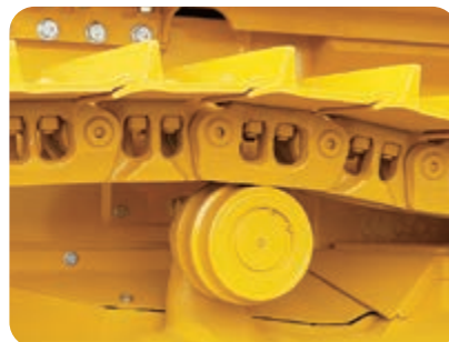
Jednotlivé články řetězu mohou být snadno vyměněny pomocí jednoho nástroje
