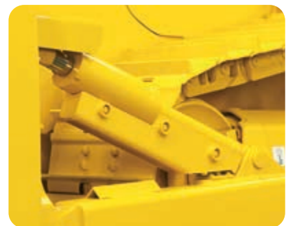
Hydraulické vedení je všude, kde je to možné, zabudováno přímo do konstrukce stroje
