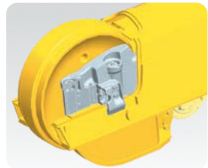
Vodící kolo s automatickým napínáním pásu
