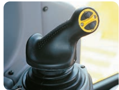
PCCS (Palm Command Control System) Systém ovládní stroje pohybem zápěstí
