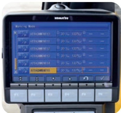
Systém integrovaného ovládání pracovního zařízení Komatsu (KIAC) umožňuje až 15 přednastavení průtoku a tlaku hydraulického systému (nastandardní)
