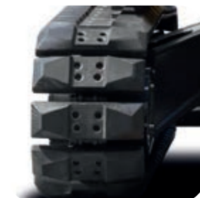
500 mm silniční (přezové) pásy (nadstandardní vybavení)
