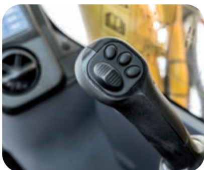
Pohodlné, ergonomické a přesné ovládání: ovládací páky s proporcionálními ovládacími tlačítky pro připojená pracovního zařízení
