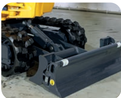
Skládací radlice přizpůsobená roztahovacímu podvozku
