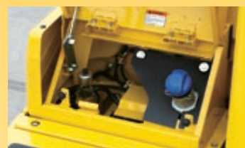
Pro snadný přístup je nádrž AdBlue® instalována na přední straně schodů.
