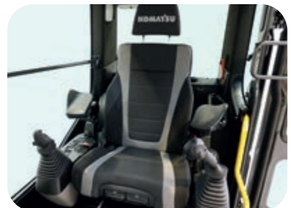
Volitelné prémiové sedadlo se špičkovým polstrováním, automatickým nastavením hmotnosti, bederní opěrkou, klimatizací, dostupné s volitelnými vícepolohovými loketními opěrkami a ergonomickými ovládacími pákami
