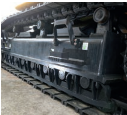
Ochrana pojezdových kladek v celé délce (nadstandard)
