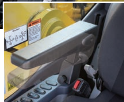
Loketní opěra s jednoduchým seřízením výšky
