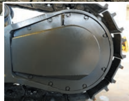
Robustní kryty pojezdového motoru
