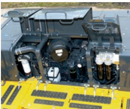
Snadný přístup k filtrům na přední straně krytu motoru
