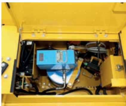
Motorizovaný mazací lis vybavený navíjecím bubnem hadic
