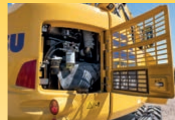
Všechny hlavní body údržby jsou snadno přístupné z úrovně terénu.
