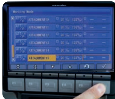
Systém integrovaného ovládání pracovního zařízení Komatsu (KIAC) umožňuje až 15 přednastavení průtoku a tlaku hydraulického systému (nastandardní)
