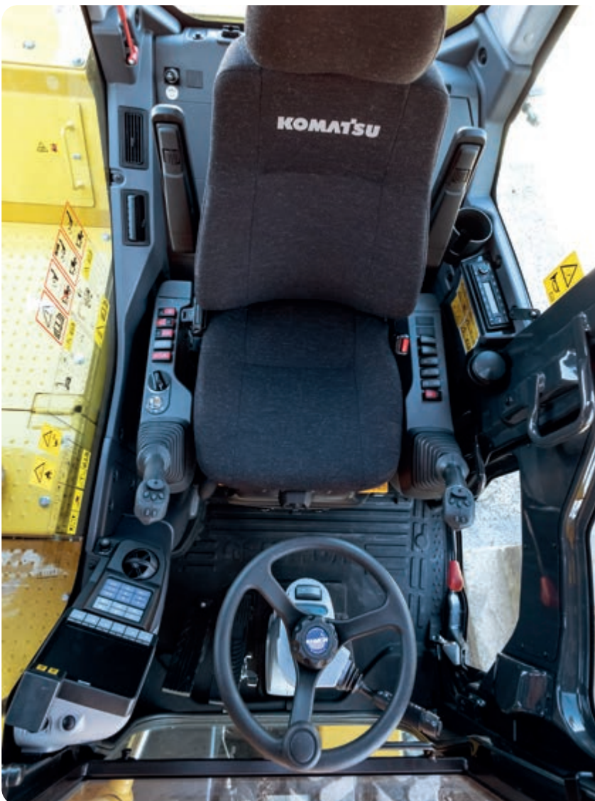
Pohodlné, ergonomické a přesné ovládání: ovládací páky s proporcionálními ovládacími tlačítky pro připojená pracovního zařízení
