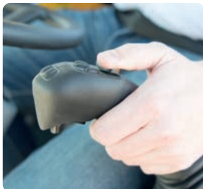
Ergonomické ovládací páky s proporcionálním ovládáním
