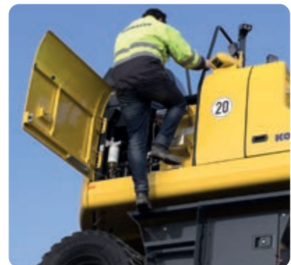
Zábradlí a protiskluzové desky
