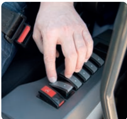
Ergonomicky navržené spínače, které jsou vybaveny osvětlením pro snadné a bezpečné ovládání při práci v noci
