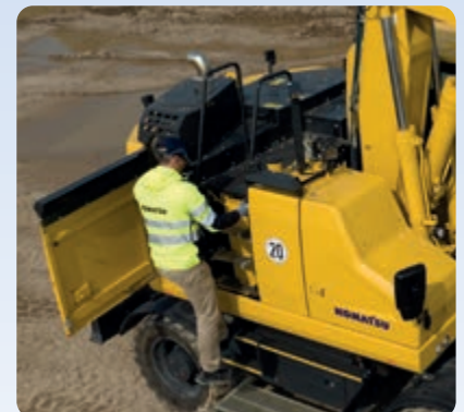
Zábradlí a protiskluzové desky pro pohodlný a bezpečný přístup k údržbě
