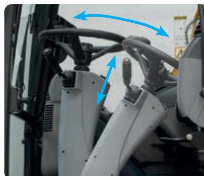
Teleskopický volant, který je součástí standardního vybavení, je pohodlně nastavitelný podle výšky a dosahu obsluhy
