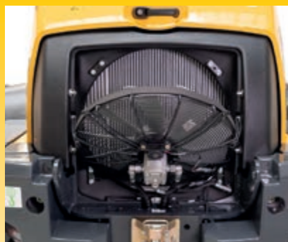
Výklopný ventilátor chladiče pro pohodlný přístup při čištění
