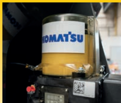
Z výroby namontovaný automatický systém mazání omezuje každodenní servisní práce na absolutní minimum (nadstandard)
