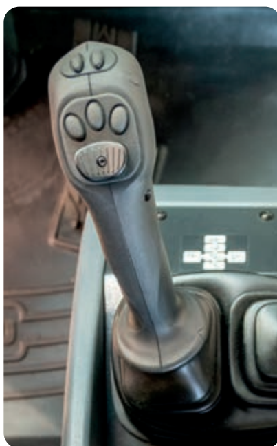
Multifunkční páka PPC s nadstandardní elektronickým ovládním 3. a 4. sekce (EPC)
