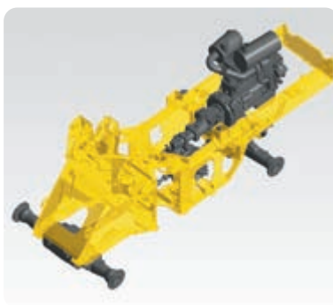
Robustní rám odolný proti torznímu namáhání
