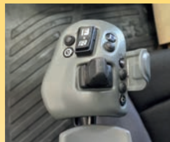
Řízení krátkou ovládací pákou Komatsu (K-SLS) (Nadstandard)
