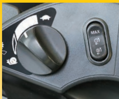
Otočný ovladač rychlosti s novým rozsahem mikropojezdu (vlevo) a spínač změny účinku systému traction control (vpravo)
