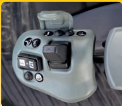
Řízení krátkou ovládací pákou Komatsu (K-SLS) (nadstandard)
