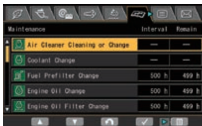
Multifunkční monitor zobrazuje a ovládá množství provozních a údržbových informací.
