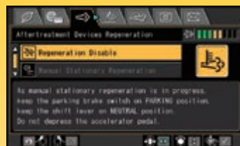
Obrazovka regenerace a následného zpracování výfukových plynů pro filtr KDPF
