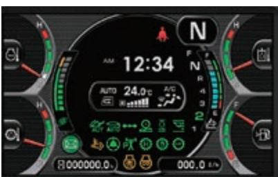
Informace na první pohled: základní LCD monitor přístrojové desky
