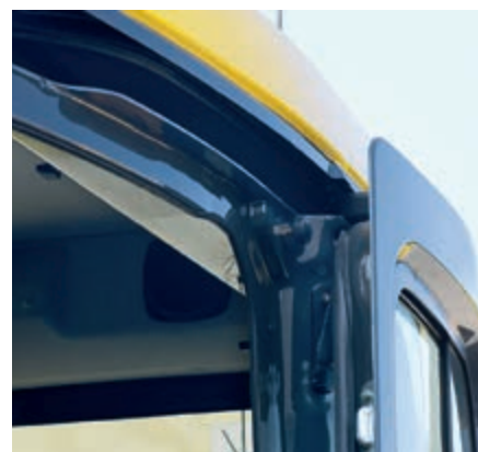
Posuvné dveře umožňují snadné nastupování v omezených prostorech a současně omezují riziko jejich poškození. Kabina je vybavena také posuvným oknem.
