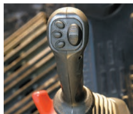
Ovládací joysticky s tlačítky pro proporcionalní ovládání příslušenství
