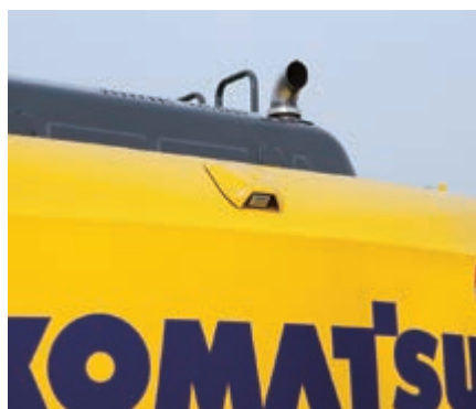
Zadní kamera nepřesahující obrys stroje
