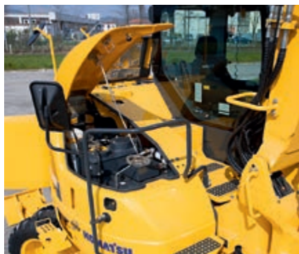
Všechny hlavní body údržby jsou snadno přístupné z úrovně terénu.
