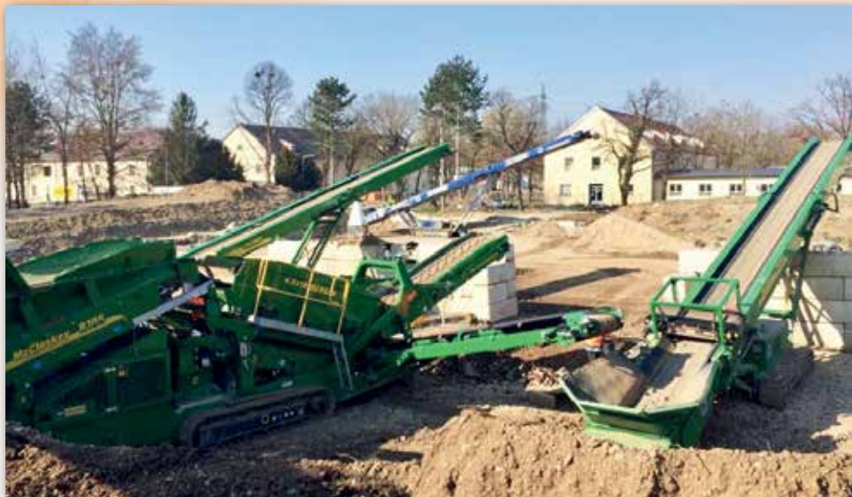
Výměna a zpracování zeminy na nejvyšší úrovni – pro tyto účely začala skupina KARL-Gruppe v nedávné době používat nová řešení k prosévání, třídění a haldování od společností McCloskey a Kuhn Baumaschinen Deutschland.
