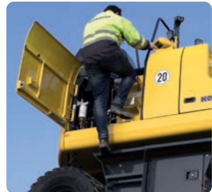
Zábradlí a protiskluzové desky
