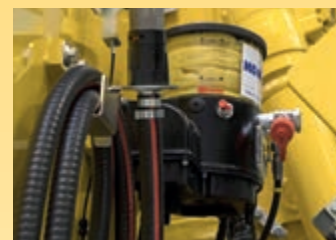
Automatický systém mazání (nadstandardní vybavení)
