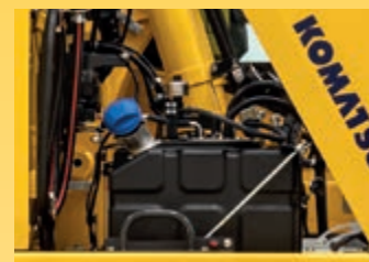
Jednoduchý přístup k nádrži s přísadou AdBlue®
