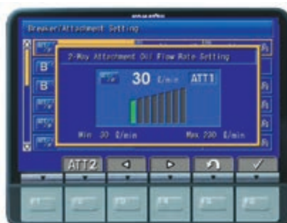
Nastavitelný průtok oleje
