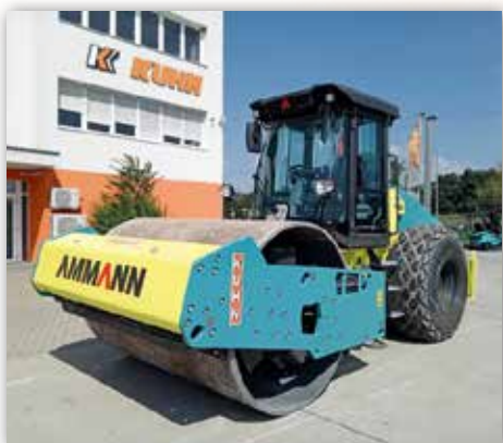
Válec Ammann ARS150 vylepšený o systém měření síly zhuťňování ACE (digitalizované protokoly o zhuťňování na stavbách).
