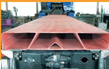
Auch später nicht sichtbare Hilfsrahmenteile werden bei KUHN optimal vor Korrosion geschützt!
